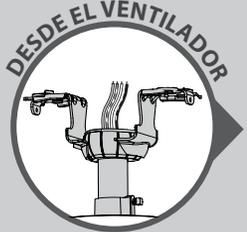
Usando un conector de alambre anaranjado de la bolsa de materiales ★, conecte los 3 alambres de puesta a tierra (verde, verde con banda amarilla, y cobre desnudo) del ventilador, la varilla y el soporte de suspensión.
