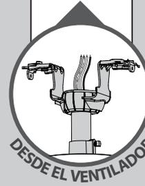
Mediante los conectores de cable naranjas de la bolsa de materiales ★, conecte el cable negro (sin puesta a tierra) del techo al cable negro del receptor (con etiqueta "live in"). Conecte el cable blanco (con puesta a tierra) del techo al cable blanco del receptor (con etiqueta "neutral in" o "common in").
