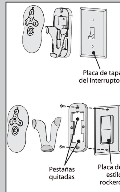
Para instalar el soporte del transmisor, quite los dos tornillos que sujetan la placa de tapa del interruptor. No retire la placa de tapa. Para orientar el soporte, alinee los dos orificios de montaje con los orificios de la placa de tapa. Coloque y apriete los tornillos. No apriete en exceso. **Nota:** Para las placas de tapa de estilo rockero, quite las pestañas empujándolas hacia afuera.
