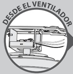
Usando un conector de alambre anaranjado de la bolsa de materiales ★, conecte los 3 alambres de puesta a tierra (verde, verde con banda amarilla, y cobre desnudo) del ventilador, la varilla y el soporte de suspensión.
