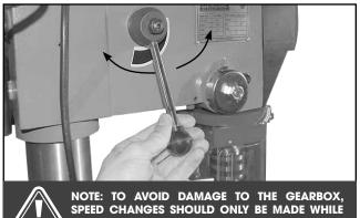
SPEED CHANGES SHOULD ONLY BE MADE W THE MACHINE IS RUNNING.
