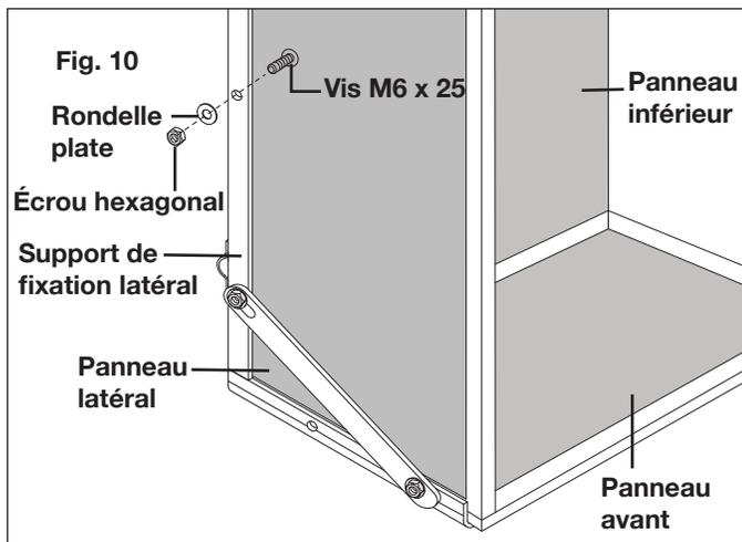
11. Attachez le panneau latéral au support de fixation avant en U à l'aide d'une vis M6 x 25, d'une rondelle plate et d'un écrou hexagonal (Fig. 11).
