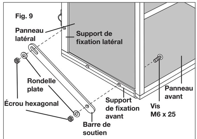
10. Attachez le panneau latéral au support de fixation latéral coulé à l'aide d'une vis M6 x 25 et d'un écrou hexagonal (Fig. 10).
