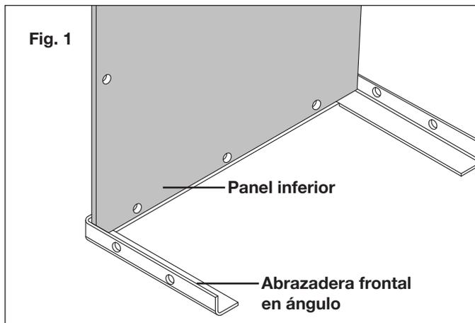
2. Empuje tres tornillos M6 x 25 a través del panel inferior y la abrazadera frontal en ángulo. Asegure los tornillos con las arandelas planas y tuercas hexagonales, y apriete (Fig. 2).
