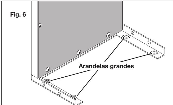
7. Pose el panel frontal sobre la abrazadera frontal en ángulo, encima de las cuatro arandelas grandes (Fig. 7).
