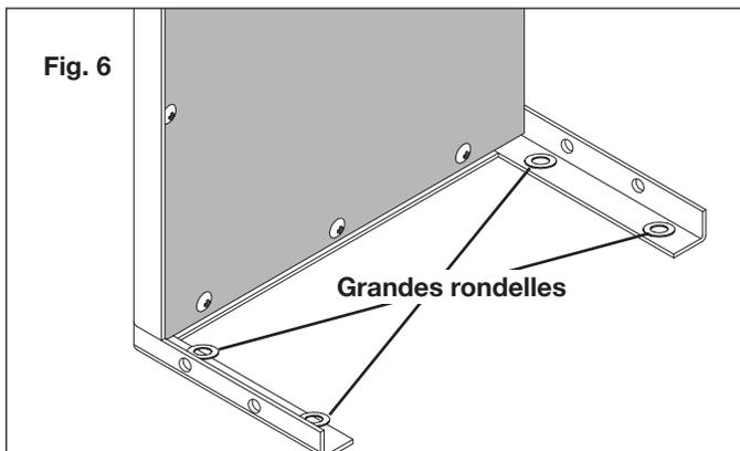
7. Posez le panneau avant sur le support de fixation avant en U, sur la partie supérieure des quatre grandes rondelles (Fig. 7).
