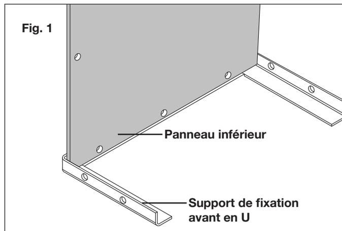
2. Enfoncez trois vis M6 x 25 à travers le panneau inférieur et le support de fixation avant en U. Attachez les vis avec les rondelles plates et les écrous hexagonaux et serrez (Fig. 2).
