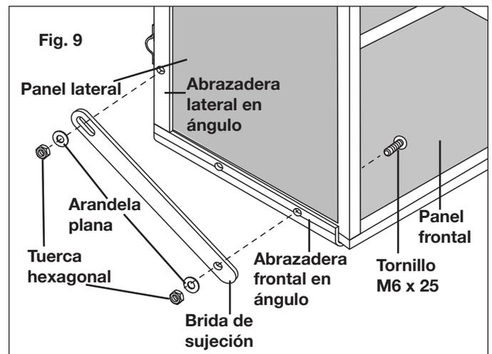
10. Asegure el panel lateral con la abrazadera lateral en ángulo mediante un tornillo M6 x 25, una arandela plana y una tuerca hexagonal (Fig. 10).
