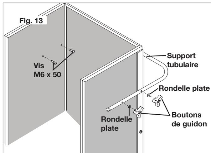
15. Placez le guidon tubulaire sur les panneaux latéraux et alignez les quatre trous. Assemblez en faisant passer quatre vis M6 x 50 à travers les panneaux latéraux et le guidon tubulaire. Attachez à l'aide des rondelles plates et des boutons de guidon (Fig. 14).
