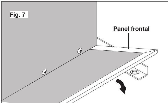
**Nota:** las arandelas grandes son usadas aquí como calzas (espaciadores) y no se ensamblarán. Serán retiradas y usadas para el ensamblado de las ruedas y eje.
