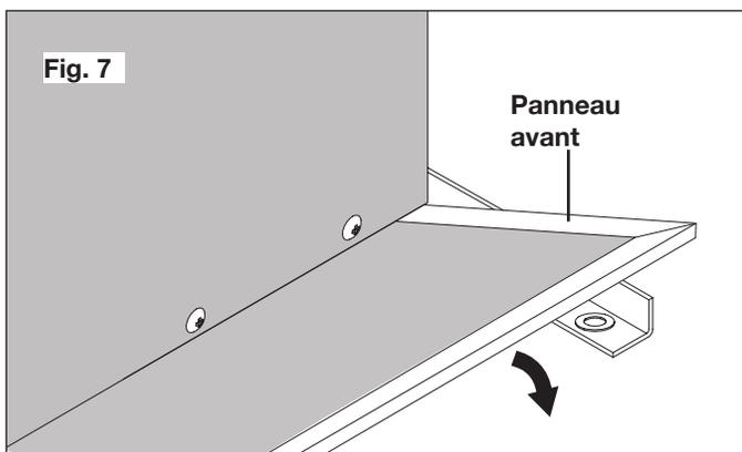
**Remarque :** les rondelles sont utilisées ici comme des cales (pièces d'écartement) et non pour l'assemblage. Elles seront retirées et utilisées pour l'assemblage des roues et des axes.
