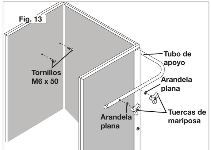
15. Coloque el tubo de agarradera por sobre los paneles laterales y alinee los cuatro orificios. Instálelo usando cuatro tornillos M6 x 50 a través de los paneles laterales y tubo de agarradera. Asegúrelo con arandelas planas y tuercas de mariposa (Fig. 14).
