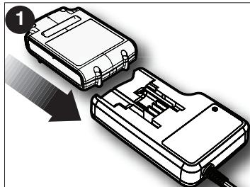
**Recharger les piles épuisées aussitôt que possible après leur utilisation pour prolonger leur durée de vie. Pour préserver le plus possible la durée de vie du bloc-piles, ne pas le décharger tout à fait.** Il est recommandé de recharger le bloc-piles après chaque utilisation.
