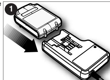
**Después del uso, recargue las baterías descargadas a la brevedad posible o de lo contrario la vida útil de las baterías podría acortarse en gran medida. Para obtener la máxima vida útil de las baterías, no permita que éstas se descarguen completamente.** Se recomienda recargar las baterías después de
