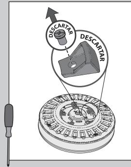
Retire los bloques para transporte del motor. Descarte los tornillos.
