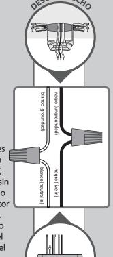
Gire los empalmes hacia arriba y presiónelos cuidadosamente hacia atrás a través del soporte de suspensión dentro de la caja de salida. Separe los alambres, con los alambres puestos a tierra a un lado de la caja de salida y los alambres no puestos a tierra al otro lado de la caja de salida.
