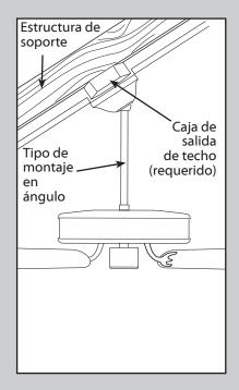
Emplee **un montaje de ángulo** para suspender el ventilador de un techo abovedado o en ángulo.
