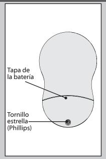
Para acceder al compartimiento de la batería quite el pequeño tornillo estrella (Phillips) que fija la tapa del compartimiento al conjunto del transmisor. La batería debe instalarse con el lado positivo (+) hacia arriba. Reemplace la batería CR2032 según sea necesario.
