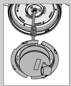
Alinee las ranuras de bocallave en el conjunto de luz con los tornillos de montaje. Asegúrese de que todos los alambres del ventilador y del conjunto de luz estén ajustados dentro del centro del conjunto de luz, y que no estén atascados entre la caja superior del interruptor y el conjunto de luz o colgando de los lados.
