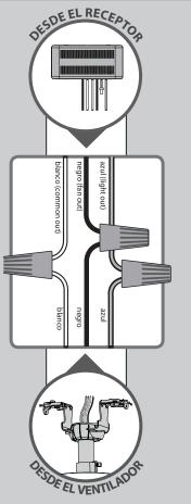
Mediante los conectores de cable naranjas de la bolsa de materiales \*\*, conecte el cable negro (sin puesta a tierra) del techo al cable negro del receptor (con etiqueta "live in"). Conecte el cable blanco (con puesta a tierra) del techo al cable blanco del receptor (con etiqueta "neutral in" o "common in").
