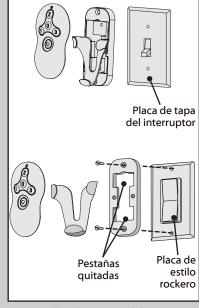
Para instalar el soporte del transmisor, quite los dos tornillos que sujetan la placa de tapa del interruptor. No retire la placa de tapa. Para orientar el soporte, alinee los dos orificios de montaje con los orificios de la placa de tapa. Coloque y apriete los tornillos.
