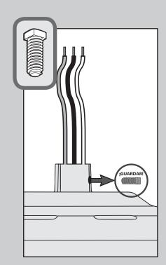
Retire el tornillo de fijación preinstalado de modo que se pueda insertar la varilla.
