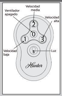
Para encender el ventilador, pulse un botón de velocidad. Las velocidades varían desde apagado (0) hasta alta (3). Presione brevemente el botón de luz para encender y apagar las luces. Mantenga el botón de luz presionado para aumentar o disminuir la intensidad lumínica.
