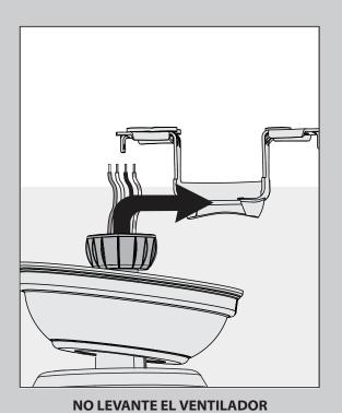
**AGARRANDO LA CAMPANA O LOS** CABLES. Coloque la bola de la varilla en la ranura del soporte de techo.
