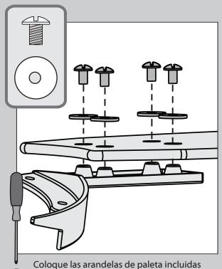
coloque las arandelas de paleta incluidas en la bolsa de materiales ■ en los tornillos de paleta incluidos en la bolsa de materiales ▲. A continuación instale los tornillos de paleta para fijar ambas paletas al soporte de paleta.
