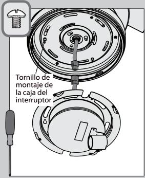
Instale parcialmente dos de los tornillos de las cajas del interruptor que están en la bolsa
