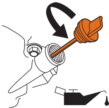
Figura 36 – Llenado de aceite del motor
