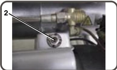
**3). FILTRE D'ENTRÉE D'AIR :** Ce filtre est prévu pour nettoyer l'air qui arrive à la pompe. Pour assurer une arrivée d'air frais à la pompe continuellement propre et sec, ce filtre doit rester toujours propre et l'ouverture de ventilation libre de toute obstruction. Le filtre peut être déposé pour un nettoyage utilisant de l'eau savonneuse chaude. Rincez ensuite le filtre et faites-le sécher.
