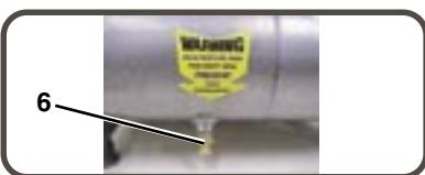
**6). ROBINET DE PURGE DU RÉSERVOIR D'AIR :** Ce robinet de purge est utilisé pour évacuer l'humidité du réservoir d'air après l'arrêt du compresseur. **Ne JAMAIS essayer d'ouvrir ce robinet quand il y a plus de 10 psi (0,68 bar) de pression dans le réservoir d'air !** Pour ouvrir ce robinet de purge, tournez son bouton dans le sens du dévissage. Penchez le réservoir pour vous assurer que toute l'eau coule bien par le robinet.
