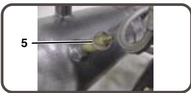
**5) VÁLVULA DE SEGURIDAD:** Esta válvula está diseñada para evitar fallas en el sistema, descargando la presión del sistema cuando el aire comprimido llega a un nivel predeterminado. La válvula es preajustada por el fabricante y no debe modificarse de manera alguna. Para verificar si la válvula está funcionando correctamente, tire del anillo. Deberá escapar presión de aire. Al soltar el anillo, se reasentará.
