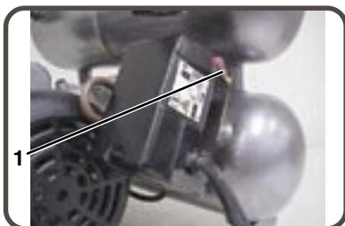
**2) PROTECTOR CONTRA SOBRECARGA DEL MOTOR:** El motor tiene un disyuntor de circuito protector ubicado en la bomba. El consumo excesivo de amperaje causará el disparo del disyunto para proteger al operador y motor. Reposicione el disyuntor oprimiendo el vástago de plástico negro hacia dentro de la caja. Reposicione el disyuntor si se dispara.
