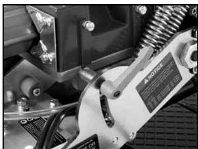
(D) Loosen the Cutting Head Height Lock.
