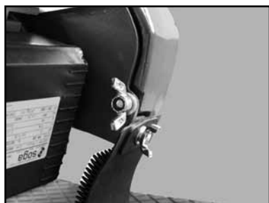
(D) Loosen the Blade Guard Pivot Point Retaining Wingnut.
