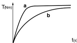
Au bout d'env. 5 secondes de frappe, on a obtenu le couple de serrage maximal.
