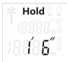
Pour interrompre le processus de mesure, actionnez la touche « HOLD » **1**. Le faisceau laser s'éteint et l'affichage **HOLD** apparaît à l'écran.
