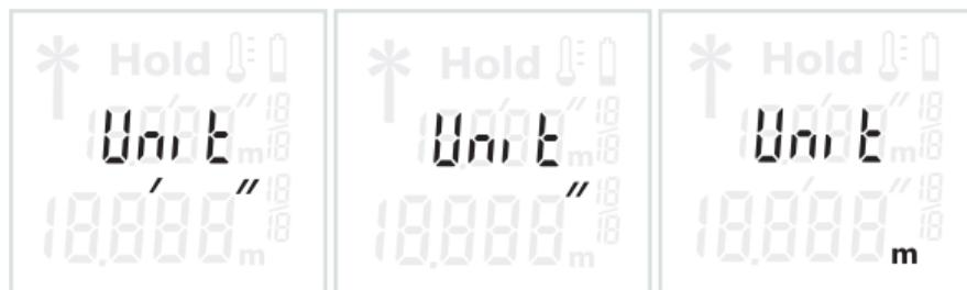
Mettez l'outil de mesure hors tension. Appuyez sur le bouton de mesure **1** et maintenez-le enfoncé. L'écran montrera alternativement les trois unités de mesure. Lorsque le réglage désiré est affiché, relâchez le bouton de mesure **1**. Le réglage est enregistré en mémoire.
