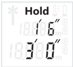
Presione de nuevo la tecla “HOLD” **1** para una repetida detención del proceso de medición. El rayo láser se desconecta y la indicación **HOLD** aparece en el display. En la línea superior se indica el valor de medición precedente. En la línea inferior se indica el valor de medición actual, pero no se sigue actualizando continuamente.
