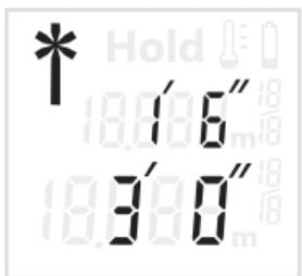
Presione de nuevo la tecla “HOLD” **1**, para conectar nuevamente el láser. La indicación **—\*** parpadea en el display. En la línea superior se indica el valor de medición precedente. En la línea inferior se indica el valor de medición actual/ continuamente actualizado.
