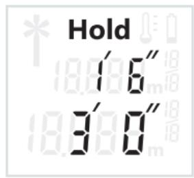
Pour interrompre une nouvelle fois le processus de mesure, actionnez à nouveau la touche « HOLD » **1**. Le faisceau laser s'éteint et l'affichage **HOLD** apparaît à l'écran. La valeur de mesure précédente s'affiche sur la ligne supérieure. La valeur de mesure actuelle s'affiche sur la ligne inférieure de l'écran mais elle n'est plus actualisée.
