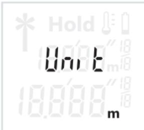
Apague la herramienta de medición. Presione el botón de medición **1** y manténgalo presionado hacia abajo. La pantalla mostrará alternadamente los tres unidades de medida. Cuando se muestre el ajuste deseado, suelte el botón de medición **1**. Se almacenará el ajuste.
