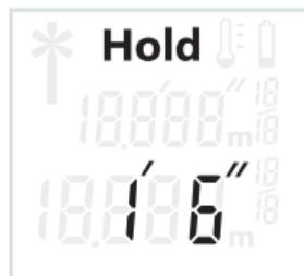
Presione la tecla “HOLD” **1** para detener el proceso de medición. El rayo láser se desconecta y la indicación **HOLD** aparece en el display. El valor de medición actual se sigue indicando en la línea inferior del display, pero no se sigue actualizando continuamente.
