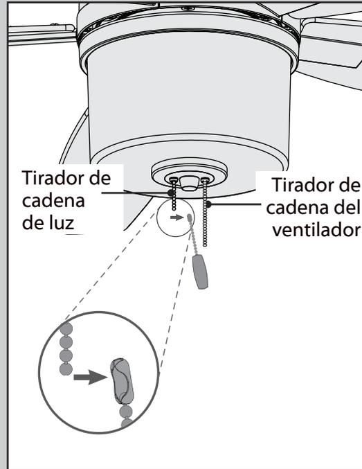
Conecte el pendiente del tirador de cadena adecuado a cada una de las cadenas cortas que vienen de la caja del interruptor.
