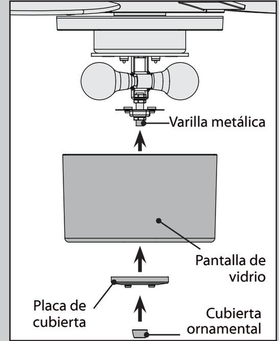
Pase los tiradores de cadena del ventilador y de la luz a través de los agujeros apropiados. Atornille esta cubierta firmemente en el extremo de la varilla roscada en los portalámparas.
