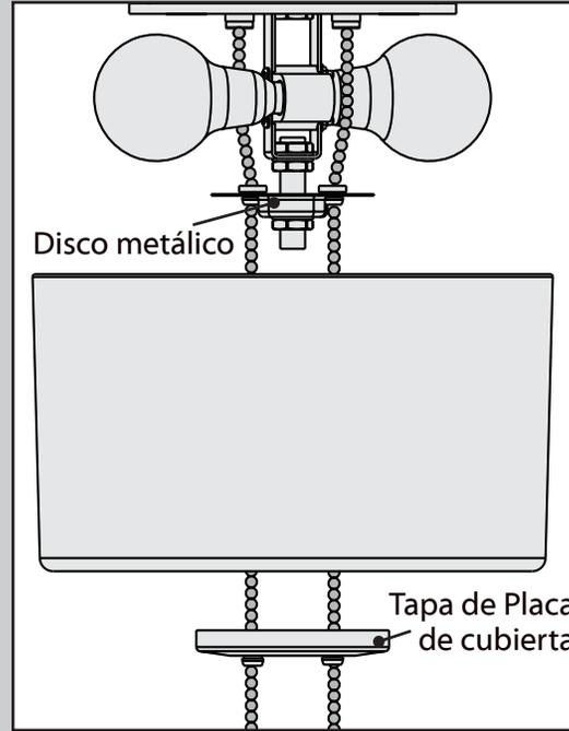
Pase los tiradores de cadena del ventilador por los agujeros en el disco de metal. Luego, pase el tirador de cadena del ventilador a través del agujero en el disco metálico. Luego, pase el tirador de cadena del ventilador a través del agujero en el centro de la pantalla de vidrio. Coloque la placa de cubierta contra la pantalla. Alinee los agujeros en la tapa de placa de cubierta y la pantalla.
