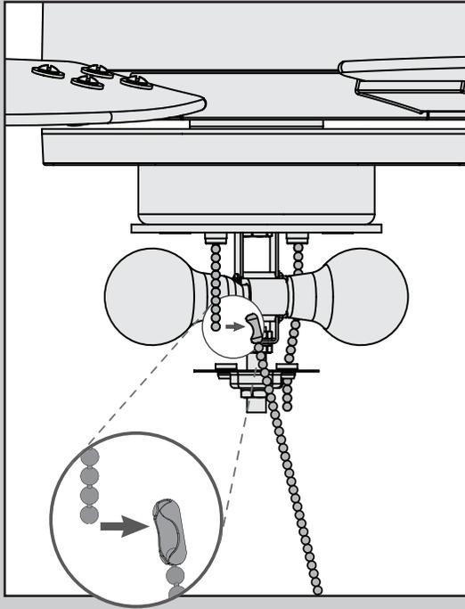
Fije el tirador de cadena adicional (incluido) al tirador de cadena del ventilador usando el conector separable. (Puede encontrar el conector separable en el extremo de la cadena adicional.)
