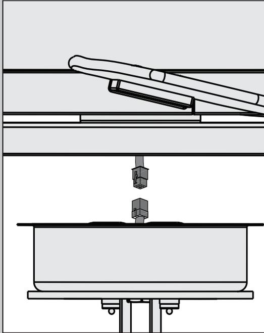
Para fijar la caja inferior del interruptor, conecte el conector superior del motor al conector inferior en el conjunto de la caja inferior del interruptor.
