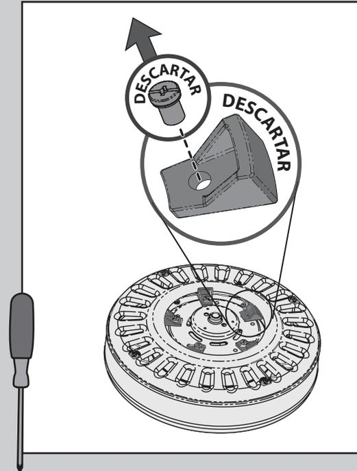
⊗ Retire los bloques para transporte del motor. Descarte los tornillos.
