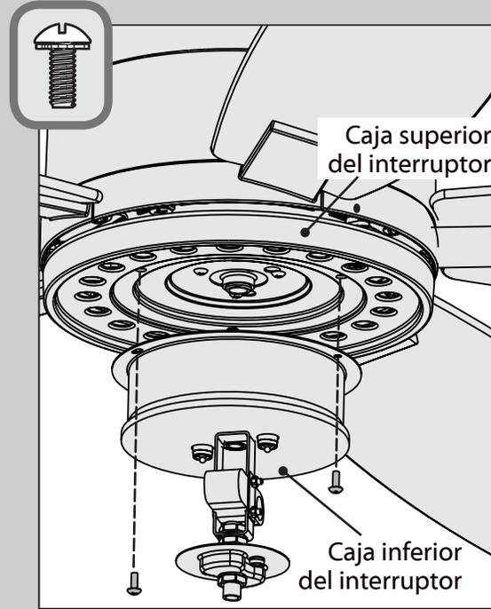
Coloque el conjunto de la caja inferior del interruptor sobre la caja superior del interruptor. Alinee los agujeros de los tornillos laterales en las cajas superior e inferior del interruptor. Fije la caja inferior del interruptor a la caja superior con tres tornillos de montaje que están en la bolsa de materiales
