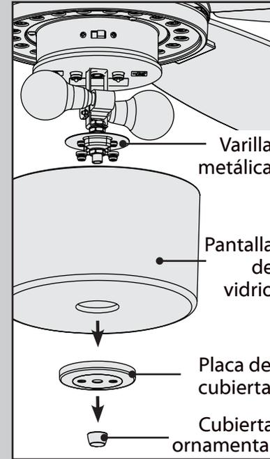
**Para cambiar las bombillas,** desenrosque la cubierta ornamental y retírela de la varilla roscada. Quite la tapa de la cubierta ornamental y mientras sostiene la pantalla con la otra mano. Quite cuidadosamente la pantalla. Desenrosque las bombillas y reemplácelas por bombillas del mismo tipo y voltaje. Reinstale el conjunto de pantalla.
