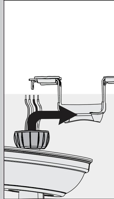
**NO LEVANTE EL VENTILADOR AGARRANDO LA CAMPANA O LOS CABLES.** Coloque la bola de la varilla en la ranura del soporte de techo.
