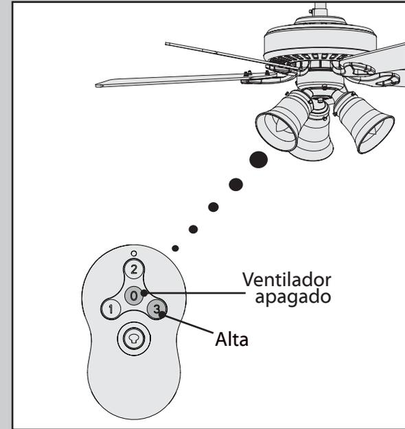
**Nota:** El control remoto debe estar sincronizado antes de operar el ventilador.
