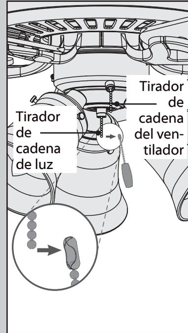
Conecte el pendiente del tirador de cadena adecuado a cada una de las cadenas cortas que vienen de la caja del interruptor.
