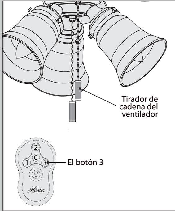
Pulse el botón 3 del transmisor remoto para más velocidad del ventilador. Tire de la cadena de velocidad del ventilador hasta que el ventilador esté en la máxima velocidad.
