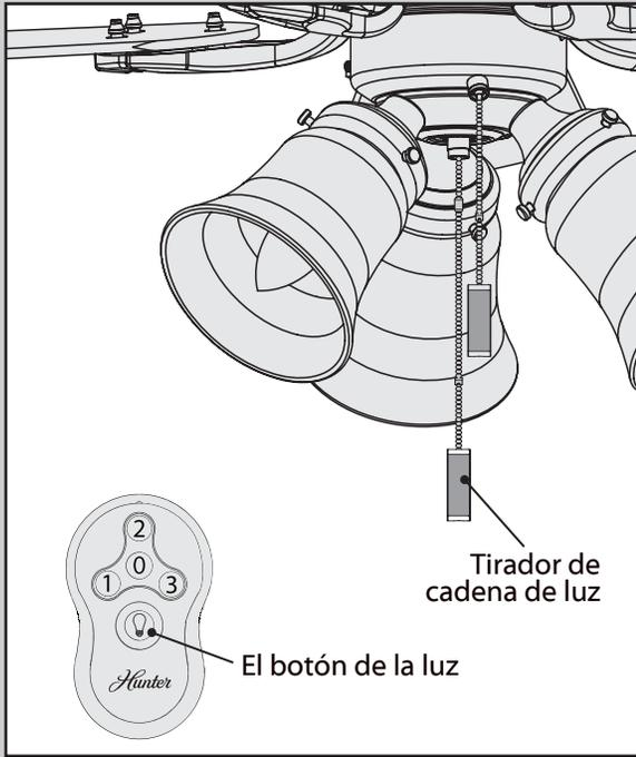
Presione el botón de la luz en el transmisor remoto. Tire de la cadena de luz una sola vez. Si la luz no se enciende, repita el paso.
