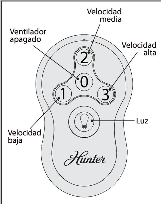
Para encender el ventilador, pulse un botón de velocidad. Las velocidades varían desde apagado (0) hasta alta (3). Presione brevemente el botón de luz para encender y apagar las luces. Mantenga el botón de luz presionado para aumentar o disminuir la intensidad lumínica.
