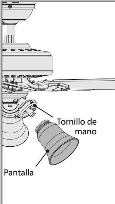
Para instalar la pantalla, primero afloje los tornillos de mano. Levante la pantalla a la lámpara. Apriete firmemente los tornillos de mano.
