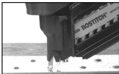
Colocación correcta del clavo
