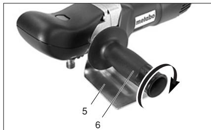
Monte a protecção das mãos (5) por cima da peça roscada no punho adicional (6). Alinhe a protecção das mãos e monte-a junto com o punho adicional.
