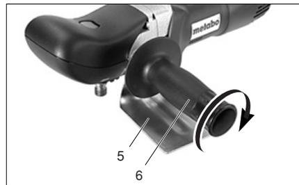
Coloque la protección para las manos (5) sobre la pieza roscada en la empuñadura complementaria (6). Enderece la protección para las manos y colóquela en la empuñadura complementaria.
