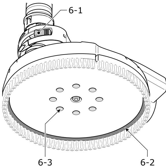
Procure que los orificios de los discos de lijar coincidan con los orificios de aspiración [6-3]. Después de usarse, el disco de lijar se puede volver a retirar fácilmente.
