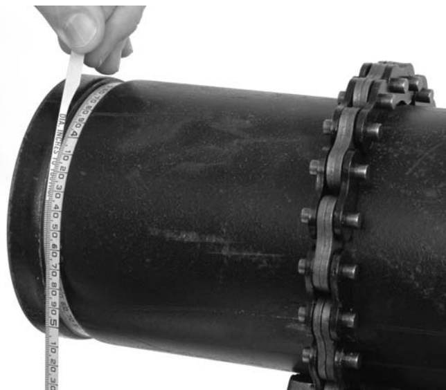
Figura 11 – Chequeo del diámetro de la ranura con una cinta mide-diámetros
