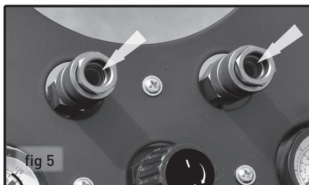
2. Vérifiez que le tuyau d'air est correctement branché au coupleur d'air en tirant sur le tuyau d'air.
