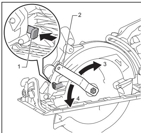
► 1. Bloqueo del eje 2. Llave poligonal 3. Aflojar 4. Apretar
