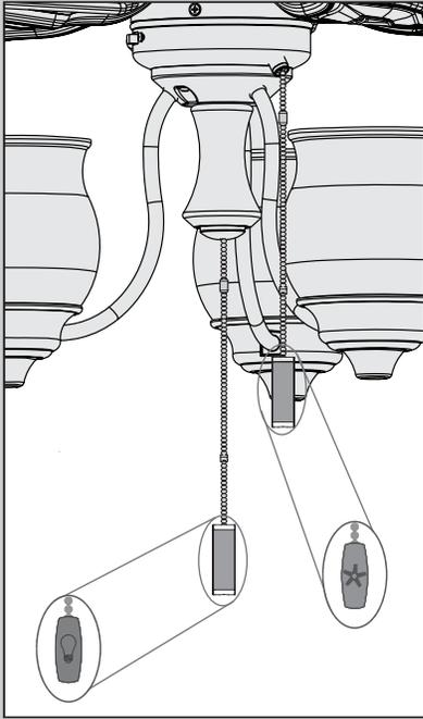
El tirador de cadena del ventilador controla la velocidad: de velocidad alta a apagado.
