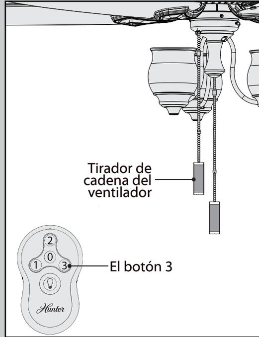
Pulse el botón 3 del transmisor remoto para más velocidad del ventilador. Tire de la cadena de velocidad del ventilador hasta que el ventilador esté en la máxima velocidad.
