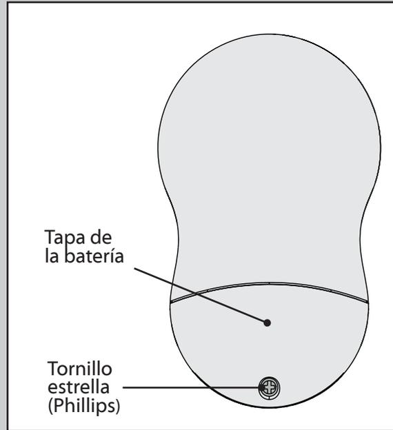
Para acceder al compartimiento de la batería quite el pequeño tornillo estrella (Phillips) que fija la tapa del compartimiento al conjunto del transmisor. La batería debe instalarse con el lado positivo (+) hacia arriba. Reemplace la batería CR2032 según sea necesario.
