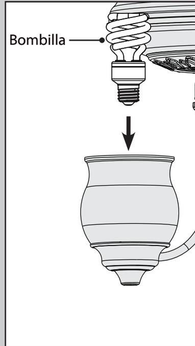
Instale una bombilla en cada uno de los portálmparas. Cuando sea necesario, reemplace las bombillas con unas de la misma potencia.
