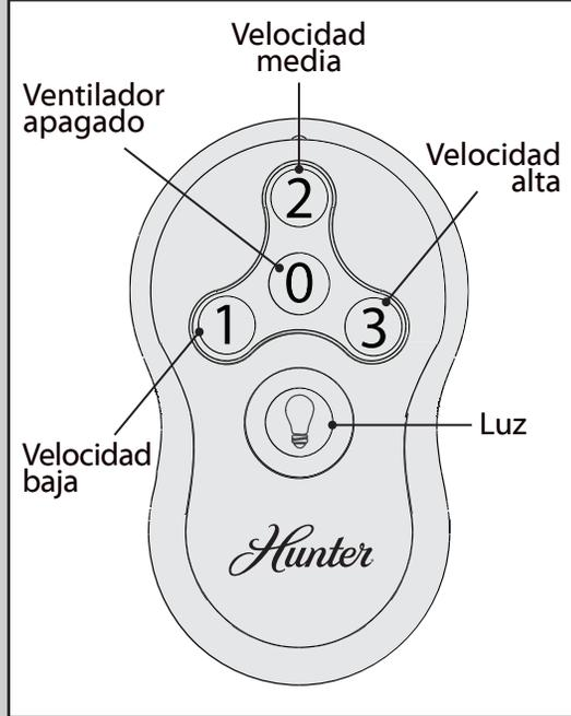
Para encender el ventilador, pulse un botón de velocidad. Las velocidades varían desde apagado (0) hasta alta (3). Presione brevemente el botón de luz para encender y apagar las luces.
