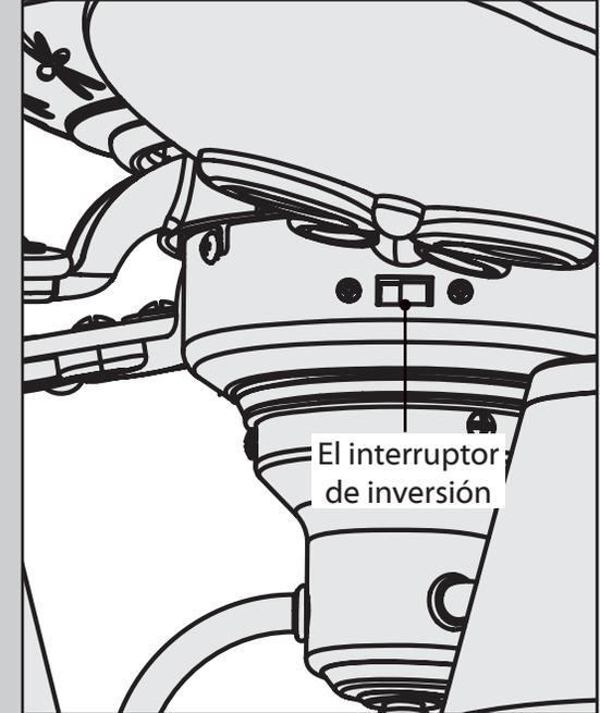
Para cambiar la dirección del flujo de aire, mueva el interruptor de inversión a la posición opuesta.
