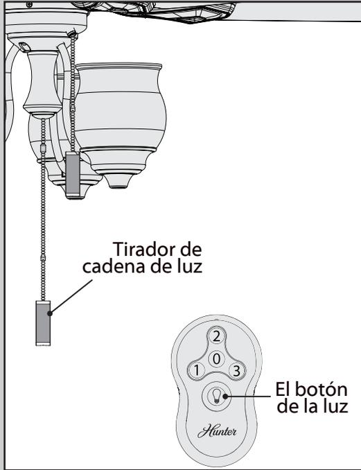
Presione el botón de la luz en el transmisor remoto. Tire de la cadena de luz una sola vez. Si la luz no se enciende, repita el paso.
