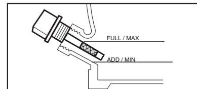
Asegúrese de que la máquina esté nivelada cuando compruebe el nivel de aceite. (Consulte el manual de funcionamiento de la máquina para los grados según la estación).
