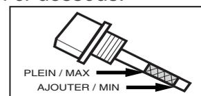
Vérifier que la machine est à l'horizontale lors du contrôle du niveau d'huile. (Se reporter au manuel d'utilisation du moteur pour connaître les différentes qualités d'huile à utiliser en fonction des saisons).
