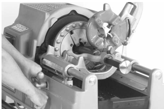
Figure 6 – Alésage à l'aide de l'alésoir N° 341
