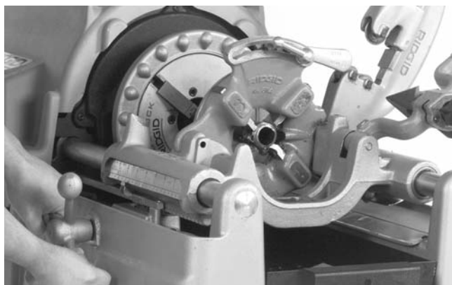
Figure 7 – Filetage des tuyaux avec la machine à fileter manuelle Modèle 535
