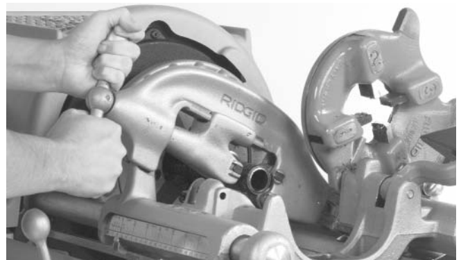
Figura 5 – Corte de un tubo con el cortatubos No. 820
