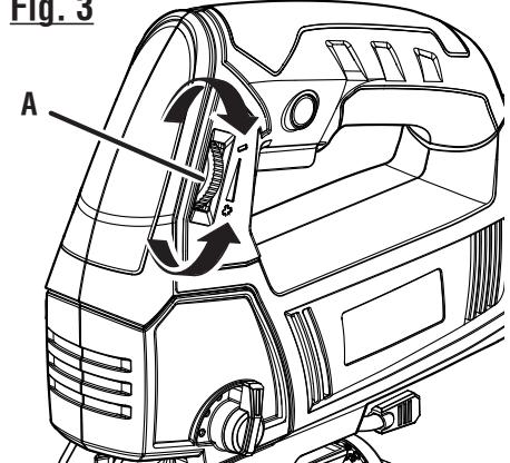
A - Variable speed control selector (sélecteur de vitesse variable, selector de control de velocidad variable)
