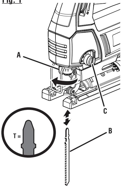
A - Clamping lever (levier de serrage, palanca de fijación)
