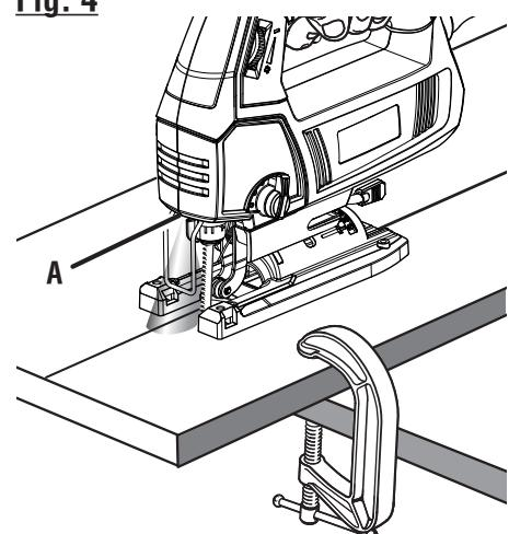
A - LED light (lampe à DEL, diodo luminiscente)
