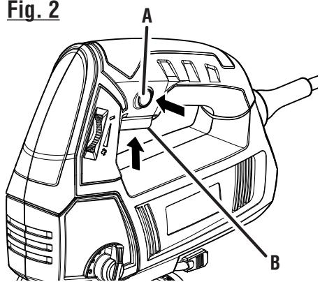
A - Lock-on button (bouton de verrouillage, botón del seguro de encendido)
