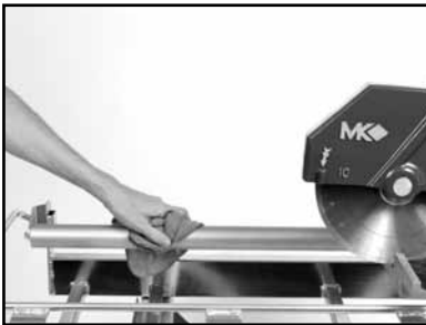
(D) Clean the Movable Cutting Table Guide Bar.
