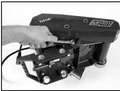
(D) Remove Belt Guard bottom bolt
