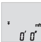
Presione y mantenga presionado el botón de función **4** hasta que se visualice la imagen mostrada a la izquierda. Use el botón **3** y el botón **6** para ciclar por las unidades de medición. Una vez que se muestre la unidad de medición deseada, presione el botón de medición **2** para regresar al modo de medición.
