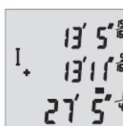
Presione el botón **6** para sumar los valores medidos o presione el botón **3** para restar los valores medidos. El resultado se mostrará en la parte inferior de la pantalla después del signo "=" y el valor medido actual se mostrará encima de dicho resultado.
