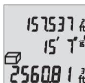
Después de completar la tercera medición, se calculará y se mostrará el volumen automáticamente. El resultado final se mostrará en la parte inferior de la pantalla, mientras que el valor medido actual se mostrará encima de dicho resultado.
