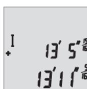
Presione el botón **6** para sumar los valores medidos o presione el botón **3** para restar los valores medidos. Aparecerá un signo "+" o un signo "-" en el centro de la pantalla. Realice otra medición. El valor medido actual se mostrará en la parte inferior de la pantalla y el valor medido previo se mostrará encima de dicho valor.
