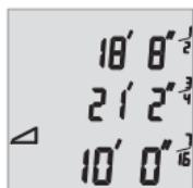
Después de completar la segunda medición, se calculará y se mostrará la altura automáticamente. El resultado final se mostrará en la parte inferior de la pantalla, mientras que el valor medido actual se mostrará encima de dicho resultado.
