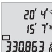
Después de completar la segunda medición, se calculará y se mostrará el área automáticamente. El resultado final se mostrará en la parte inferior de la pantalla, mientras que el valor medido actual se mostrará encima de dicho resultado.
