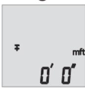
Appuyez sur le bouton de fonction **4** et maintenez-le enfoncé jusqu'à ce que l'image montrée à gauche soit affichée. Utilisez le bouton **3** et le bouton **6** pour passer d'une unité de mesure à une autre. Après l'affichage de l'unité de mesure désirée, appuyez sur le bouton de
