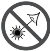
Ne dirigez pas le faisceau laser en direction de personnes ou d'animaux, et ne regardez pas directement le faisceau laser vous-même. Cet instrument produit des rayonnements laser de classe 2 et est conforme aux normes 21 CFR 1040.10 et 1040.11, à l'exception des déviations en vertu de l'Avis relatif au laser N° 50 daté du 24 juin 2007.
