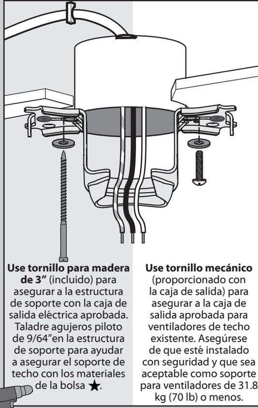
**Use tornillo para madera de 3"** (incluido) para asegurar a la estructura de soporte con la caja de salida eléctrica aprobada. Taladre agujeros piloto de 9/64" en la estructura de soporte para ayudar a asegurar el soporte de techo con los materiales de la bolsa ★.
