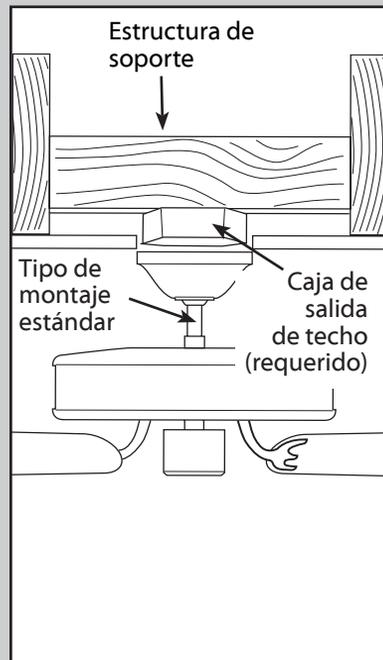
Emplee **un montaje estándar** o **un montaje de perfil bajo** para suspender el ventilador de un techo plano.
