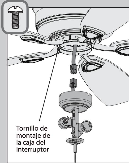
Tornillo de montaje de la caja del interruptor
