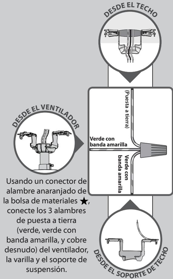
Usando un conector de alambre anaranjado de la bolsa de materiales ★, conecte los 3 alambres de puesta a tierra (verde, verde con banda amarilla, y cobre desnudo) del ventilador, la varilla y el soporte de suspensión.
