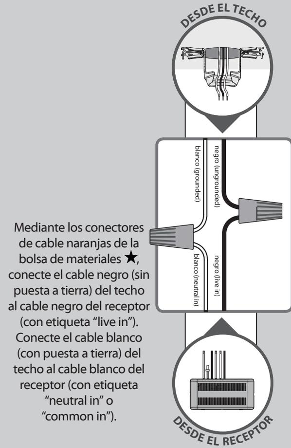
Mediante los conectores de cable naranjas de la bolsa de materiales ★, conecte el cable negro (sin puesta a tierra) del techo al cable negro del receptor (con etiqueta "live in"). Conecte el cable blanco (con puesta a tierra) del techo al cable blanco del receptor (con etiqueta "neutral in" o "common in").
