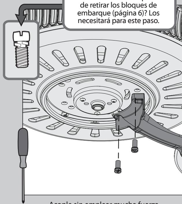
Acople sin emplear mucha fuerza los soportes de paleta al motor con los tornillos de armadura de soporte de paleta y a continuación apriete con firmeza una vez que ambos tornillos estén acoplados.
