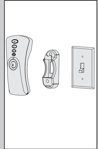
Para instalar el soporte del transmisor, quite los dos tornillos que sujetan la placa de tapa del interruptor. No retire la placa de tapa. Para orientar el soporte, alinee los dos orificios de montaje con los orificios de la placa de tapa. Coloque y apriete los tornillos. No apriete en exceso.
