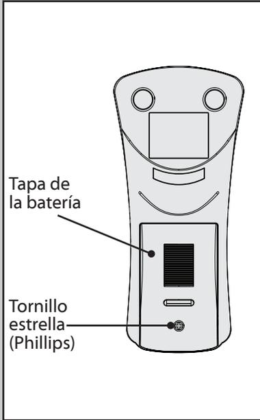
Para acceder al compartimiento de la batería quite el pequeño tornillo estrella (Phillips) que fija la tapa del compartimiento al conjunto del transmisor. La batería debe instalarse con el lado positivo (+) hacia arriba. Reemplace la batería CR2032 según sea necesario.
