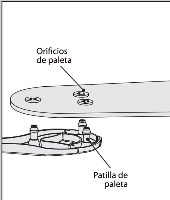
Alinee los tres orificios de paleta con las tres patillas de paleta. Presione para unir la paleta y las patillas de paleta.
