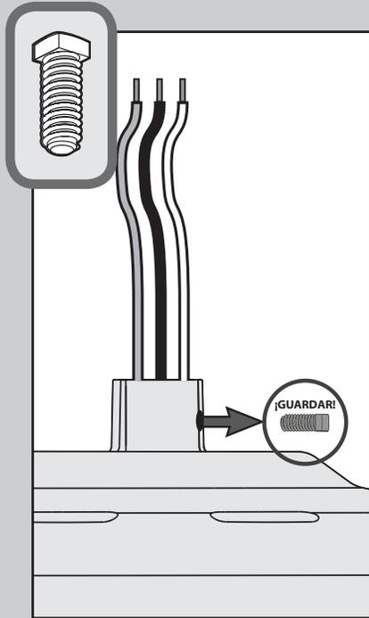
Retire el tornillo de fijación preinstalado de modo que se pueda insertar la varilla.
