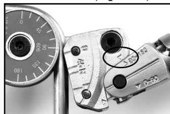
Figura 13 – Gire el Brazo del Carril
