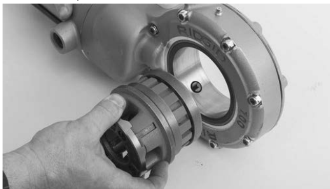
4. ábra – Menetvágó fejek beszerelése a 700 sorozatú motoros hajtóegységbe
