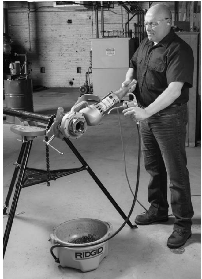
Figure 9 – Filetage des tuyaux
