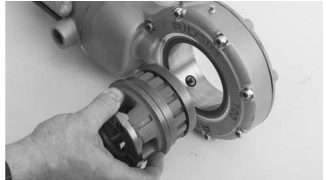
Рис. 4 – Установка резьбонарезных головок в силовой привод модели 700
