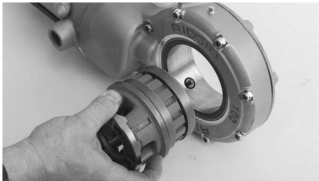
Obrázek 4 – instalace závitorežných hlav do elektrické závitnice 700
