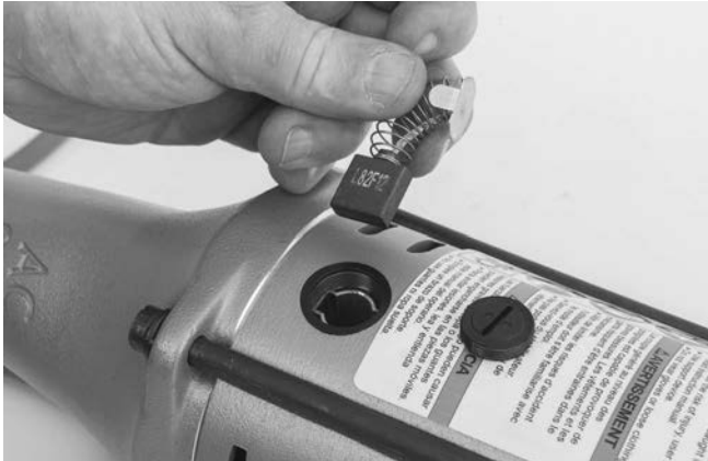
Figura 13 – Installazione della spazzola
