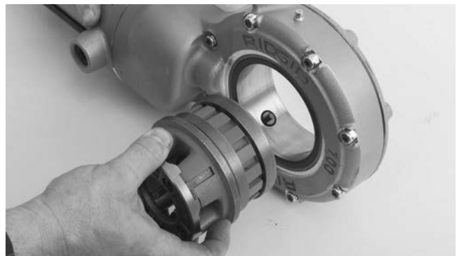
Figura 4 – Installazione delle Teste portapettini nella Filettatrice 700
