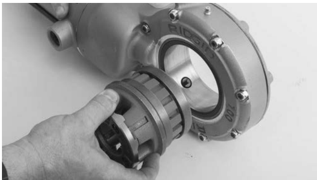
Kuva 4 – Kierrepäiden asennus 700-käyttölaitteeseen
