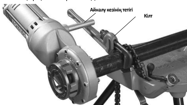
7-сурет – Құбыр кілтін бұрандама қысқыш ретінде пайдаланып, бұранда кесу
