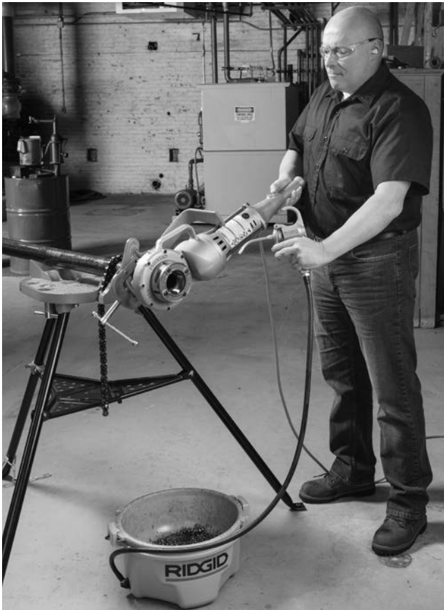
Figura 9 – Roscado de un tubo
