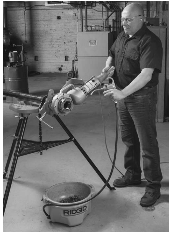
Рис. 9 – Нарезание резьбы на трубе
