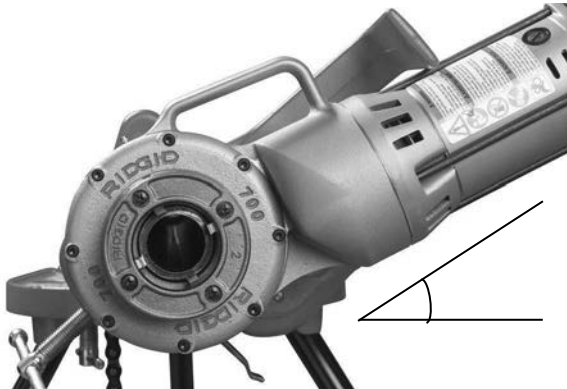
Figur 6 – Støttearmen er placeret med det elektriske rørdrev 700 en anelse over den vandrette linje
