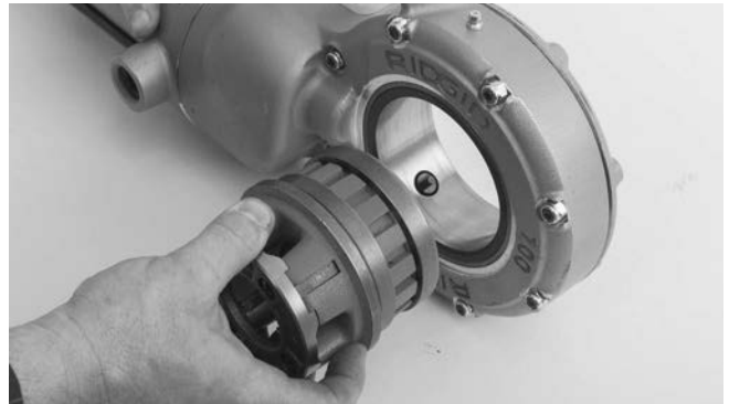
Figura 4 – Montarea capetelor filieră în clupa electrică 700
