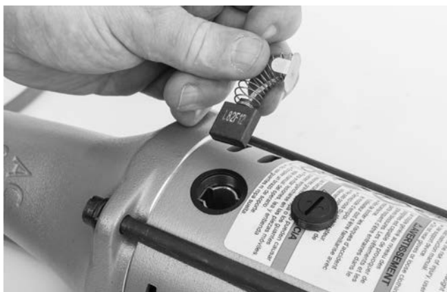
Figura 13 – Colocación de la escobilla
