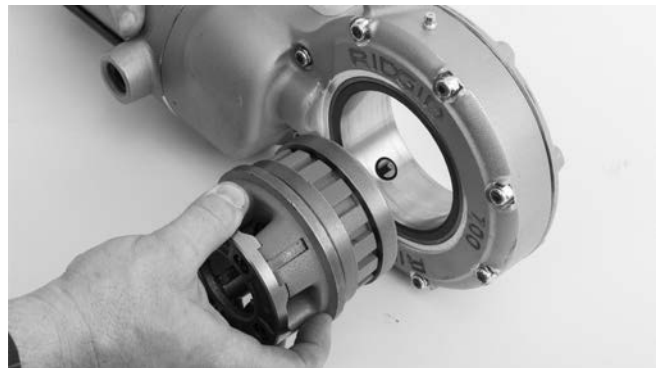
Figure 4 – Montage des têtes de filière sur le système d'entraînement électrique N° 700
