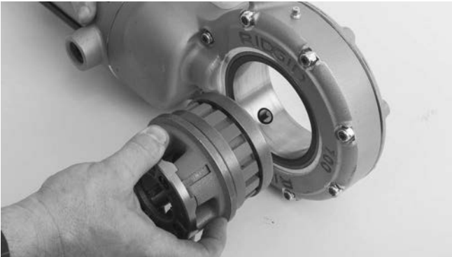
Şekil 4 – Pafta Kafalarının 700 Elektrikli El Paftasına Takılması
