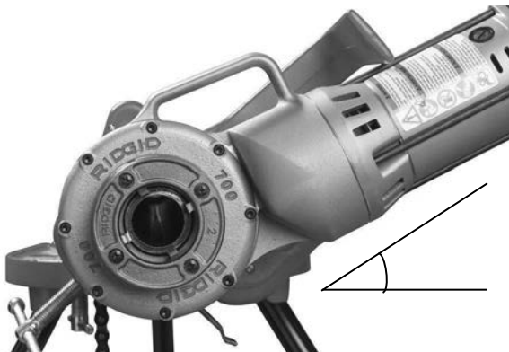
Obrázok 6 – Umiestnené podporné rameno s elektrickým pohonom 700 mierne nad vodorovnou úrovňou
