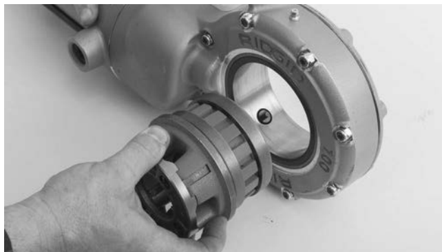
Rysunek 4 – Montaż głowic gwinciarzskich do napędu elektrycznego 700 Power Drive.
