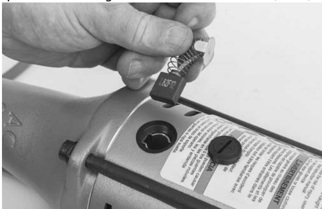
Figura 13 – Instalação da Escova
