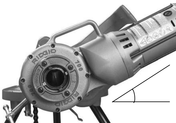
Figur 6 – Støttearm plassert med 700 Power Drive drivenhet litt over horisontal
