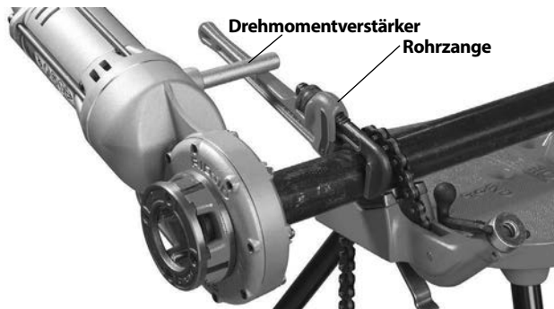
Abbildung 7 – Gewindeschneiden mit Rohrzanze als Stützarm
