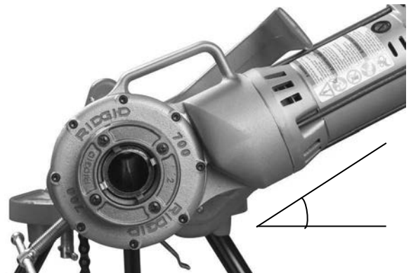
Abbildung 6 – Stützarm positioniert, Kraftantrieb 700 leicht über der Horizontalen
