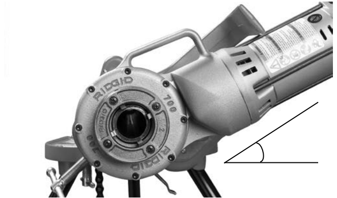
Figura 6 – Brazo de soporte con el accionamiento motorizado 700 colocado ligeramente encima de la línea horizontal
