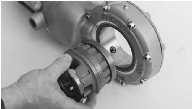
Slika 4 – Postavljanje nareznih glava u nareznu glavu 700
