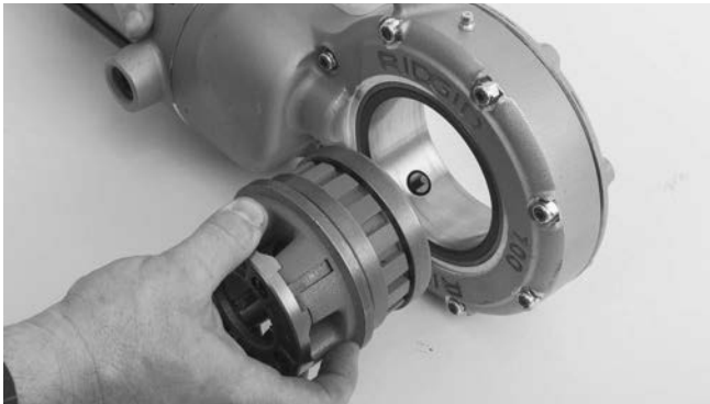
Figuur 4 – Draadsnijkoppen aanbrengen in de Power Drive 700
