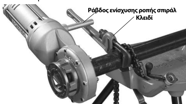
Εικόνα 7 – Ελικοτόμηση με χρήση κλειδιού σωλήνα ως βραχίονα αντιστήριξης
