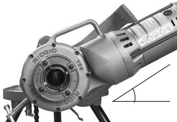
Kuva 6 – Tukivarsi sijoitettuna ja 700-käyttölaite hieman vaakataso yläpuolella
