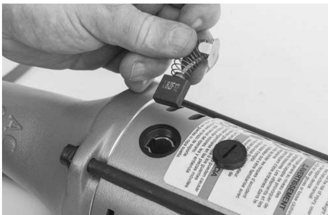
13. ábra – A kefék beszerelése
