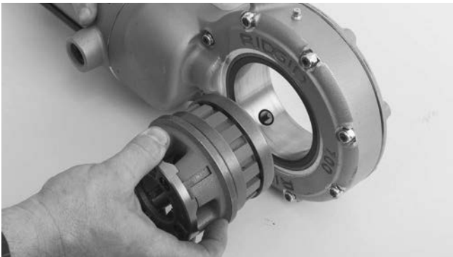
Figur 4 – Installere gjengehoder i 700 Power Drive drivenhet
