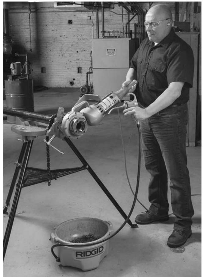
Figur 9 – Gjenging av rør
