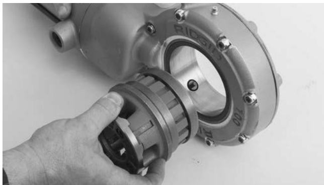
Obrázok 4 – Inštalácia závitorezných hláv do elektrického pohonu 700
