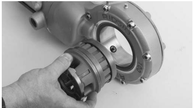
Slika 4 – Vgradnja rezalnih glav v električni pogon 700-I
