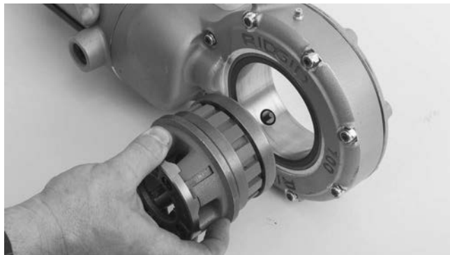
Figur 4 – Montera gänghuvuden i drivenheten 700 Power Drive
