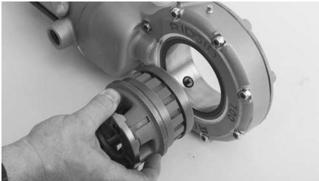
Εικόνα 4 – Τοποθέτηση φιλιέρων στον ηλεκτρικό βιδολόγο 700
