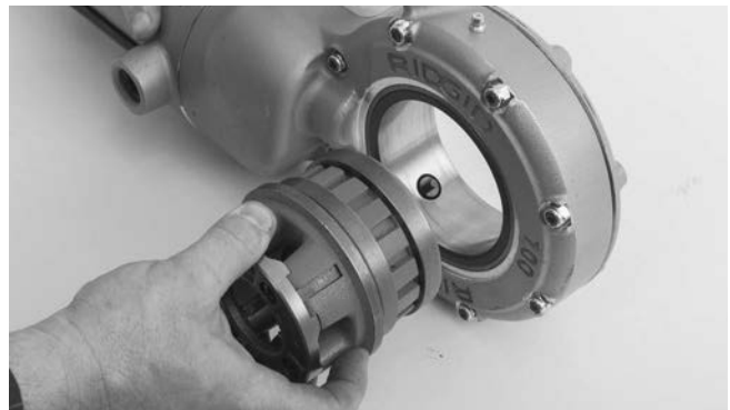
Slika 4 – Stavljanje narezne glave u električnu nareznicu 700
