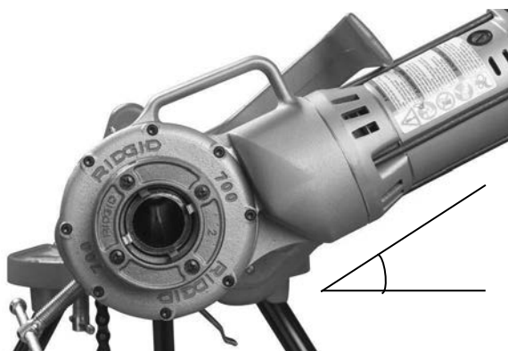
Rysunek 6 – Ramie podporowe ustawione z napędem 700 Power Drive nieco powyżej pozycji poziomej
