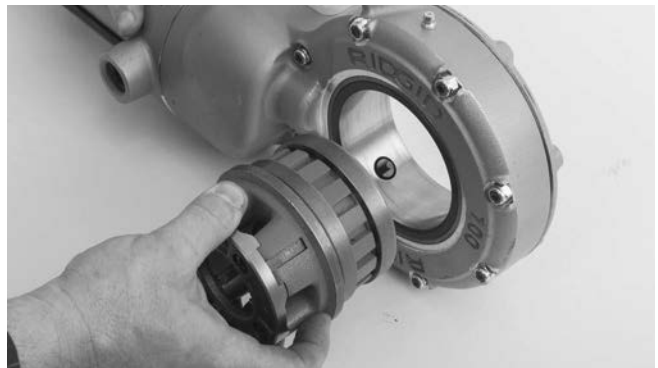
Figura 4 – Instalar cabeças de rosca no Propulsor 700
