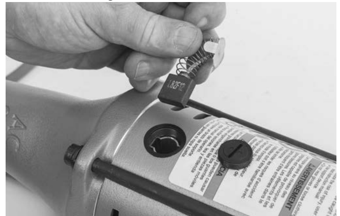
Abbildung 13 – Einbau der Bürsten
