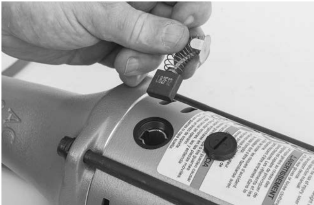
Rysunek 13 – Montaż szczotek
