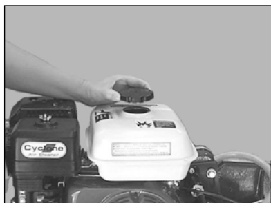
(D) Install Fuel Cap DO NOT over-tighten.
