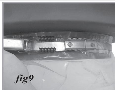
9. **ATTACHEZ LE BOYAU (K,** fig 10) à l'orifice à la partie basse de l'assemblage ventilateur / séparateur (D) avec un des colliers de serrage (J)..
