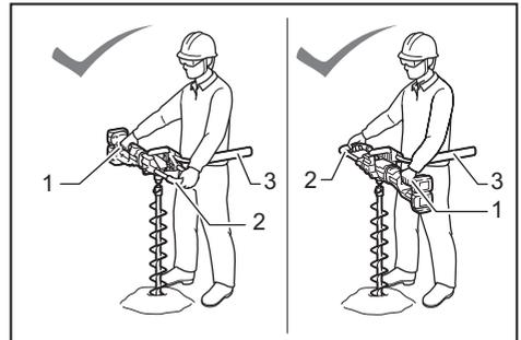
► 1. Mango 2. Mango lateral 3. Barra de la unidad receptora de reacción
