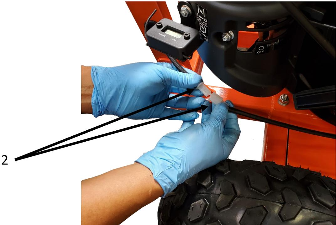
**STEP 4: SECURE THE THROTTLE CABLE**
