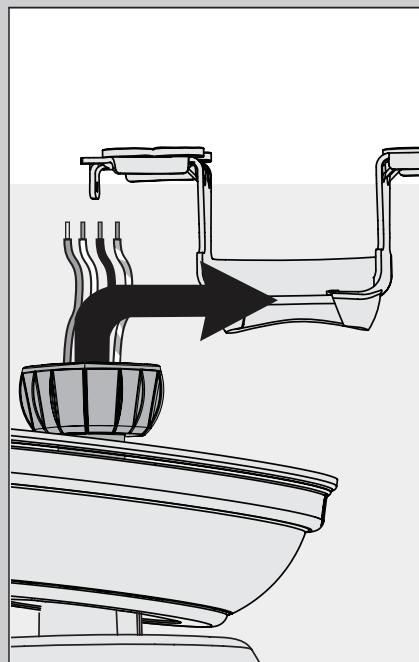
**NO LEVANTE EL VENTILADOR AGARRANDO LA CAMPANA O LOS CABLES.** Coloque la bola de la varilla en la ranura del soporte de techo.
