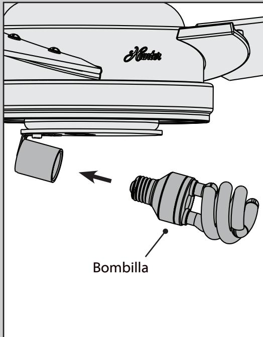
Instale bombillas de CFL de 18W incluidas con el ventilador. Cuando sea necesario, reemplace las bombillas con unas de la misma potencia.
