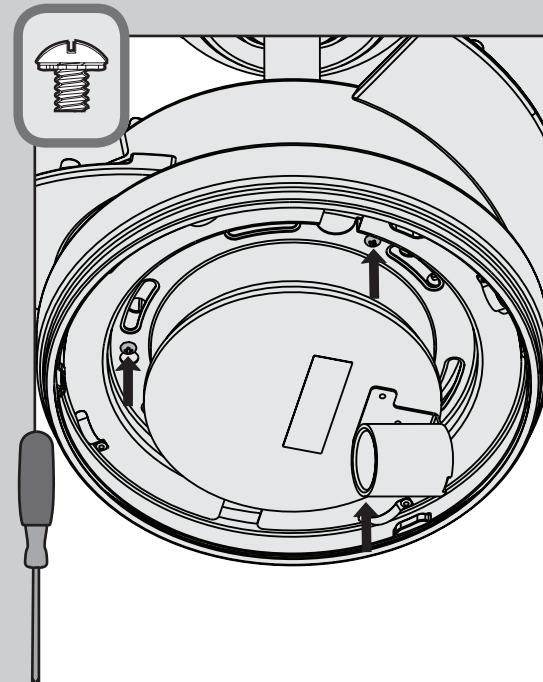
✗ Gire el conjunto de luz en sentido antihorario hasta que los tornillos de ensamblaje de la caja estén firmemente colocados en el extremo angosto de las ranuras de bocallave. Instale el tornillo restante en la caja. Apriete los tres tornillos firmemente.
