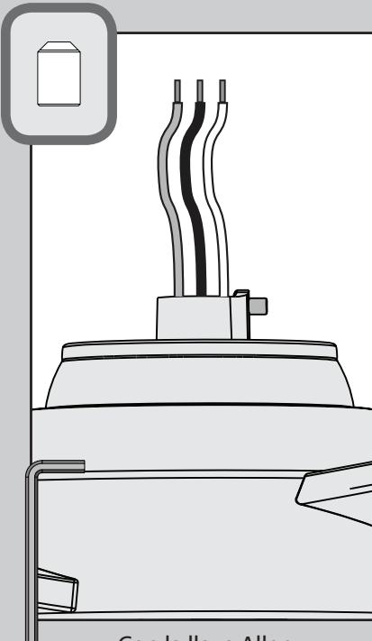
Con la llave Allen proporcionada, afloje el tornillo de fijación en el adaptador para instalar el conjunto de tubo y bola.
