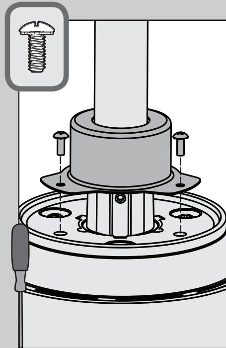
Instale tres tornillos de cubierta del adaptador y apriete los tres tornillos firmemente.
