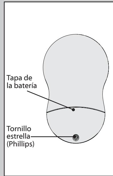
Para acceder al compartimiento de la batería quite el pequeño tornillo estrella (Phillips) que fija la tapa del compartimiento al conjunto del transmisor. La batería debe instalarse con el lado positivo (+) hacia arriba. Reemplace la batería CR2032 según sea necesario.
