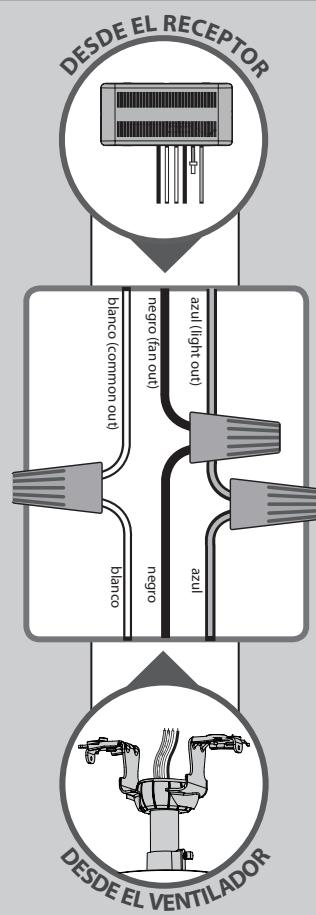
Mediante los conectores de cable naranjas de la bolsa de materiales ★, conecte el cable negro (sin puesta a tierra) del techo al cable negro del receptor (con etiqueta "live in"). Conecte el cable blanco (con puesta a tierra) del techo al cable blanco del receptor (con etiqueta "neutral in" o "common in").
