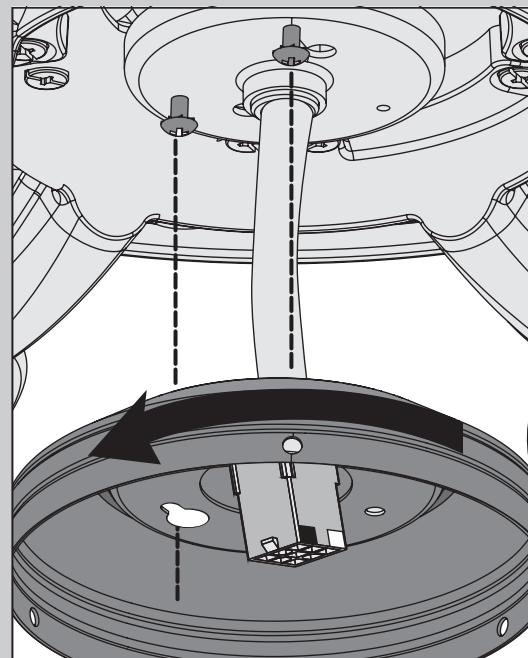
Pase la clavija del cable a través del agujero central de la caja superior del interruptor, luego envuelva la ranura de bocallave alrededor de los tornillos y gire en sentido antihorario.
