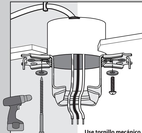
**Use tornillo para madera de 3"** (incluido) para asegurar a la estructura de soporte con la caja de salida eléctrica aprobada. Taladre agujeros pilotos de 9/64" en la estructura de soporte para ayudar a asegurar el soporte de techo con los materiales de la bolsa ★.
