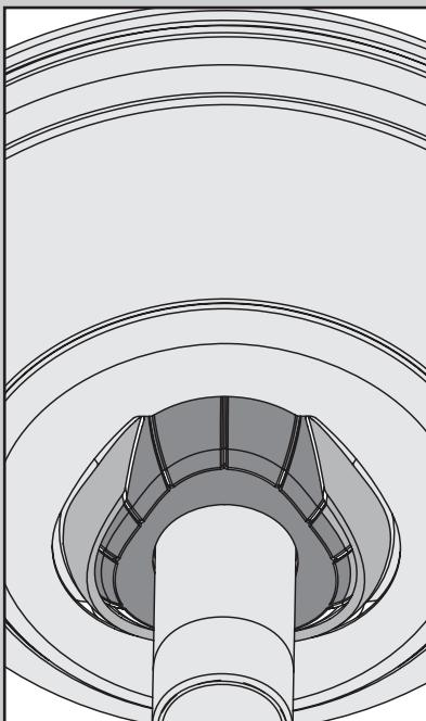
Coloque la campana de modo que, cuando sea levantada para ponerla en posición, encaje en el soporte de suspensión como se muestra.
