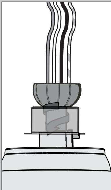
Introduzca la varilla a través de la cubierta del adaptador. Apriete girando la varilla (por lo menos 4-5 vueltas completas) hasta que se detenga.
