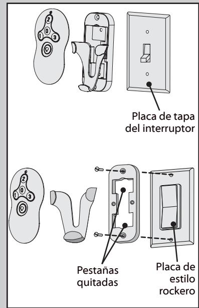
Para instalar el soporte del transmisor, quite los dos tornillos que sujetan la placa de tapa del interruptor. No retire la placa de tapa. Para orientar el soporte, alinee los dos orificios de montaje con los orificios de la placa de tapa. Coloque y apriete los tornillos. No apriete en exceso.
