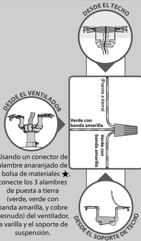
**Nota:** Para conectar los alambres, sostenga los extremos desnudos de los alambres juntos y coloque un conector sobre ellos; luego tuerza en el sentido horario hasta que queden apretados.
