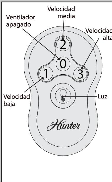
Para encender el ventilador, pulse un botón de velocidad. Las velocidades varían desde apagado (0) hasta alta (3). Presione brevemente el botón de luz para encender y apagar las luces.
