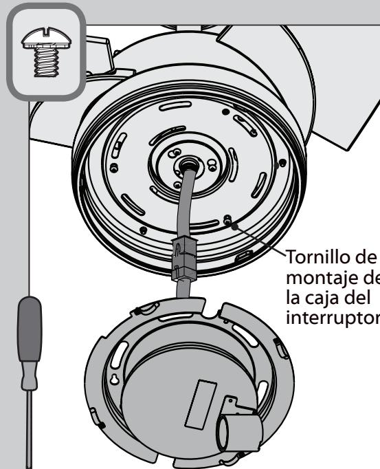
✗ Instale parcialmente dos de los tornillos de las cajas del interruptor que están en la bolsa . Alinee las ranuras de bocallave en el conjunto de luz con los tornillos de montaje. Asegúrese de que todos los alambres del ventilador y del conjunto de luz estén ajustados dentro del centro del conjunto de luz, y que no estén atascados entre la caja superior del interruptor y el conjunto de luz o colgando de los lados.
