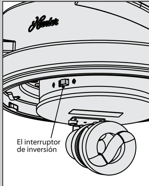
Para cambiar la dirección del flujo de aire, mueva el interruptor de inversión a la posición opuesta.
