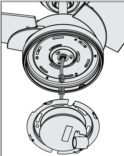
Conecte las clavijas de las cajas superior e inferior del interruptor. Asegúrese de alinear las marcas de color de los conectores.
