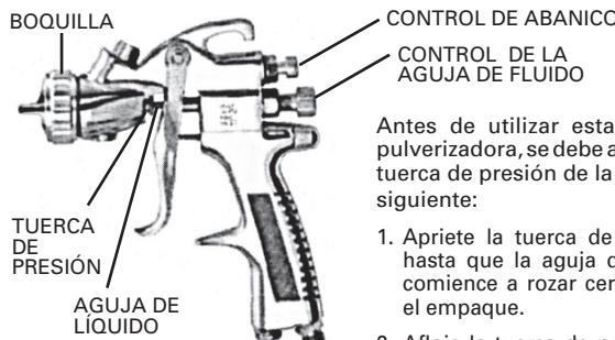
Antes de utilizar esta pistola pulverizadora, se debe ajustar la tuerca de presión de la manera siguiente:
