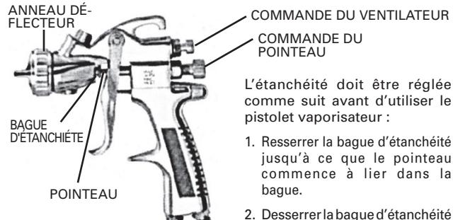
L'étanchéité doit être réglée comme suit avant d'utiliser le pistolet vaporisateur :
